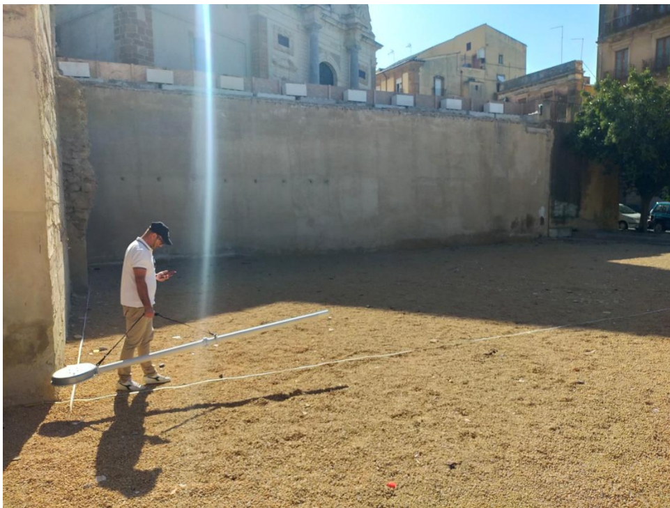
Esempio di una fase di acquisizione con Elettromagnetometro
