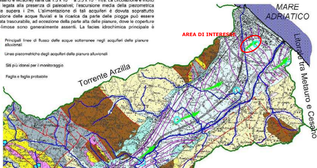
FIGURA 3-8 – STRALCIO DELLO SCHEMA IDROGEOLOGICO DEL BACINO DEL FIUME METAURO (FONTE: HTTP://WWW.REGIONE.MARCHE.IT/REGIONE-UTILE/AMBIENTE/TUTELA-DELLE-ACQUE/PTA#DOCUMENTAZIONE )
