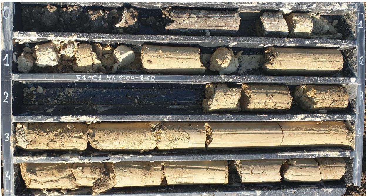
Cassa 1 – dal p.c. a 5 m di profondità
