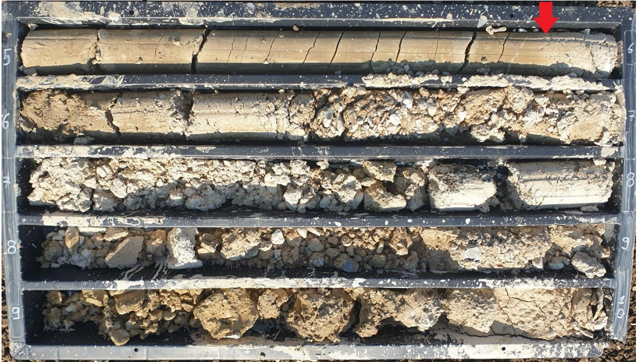
Figura 7.3: Foto della cassa n°2 (da 5 a 10 m di profondità) del terreno prelevato nel sondaggio eseguito. La freccia rossa indica il passaggio dai depositi fini ai sottostanti depositi granulari (ghiaie e sabbie prevalenti).
