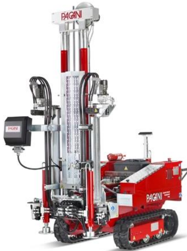
Figura 6.2: mezzo utilizzato per la realizzazione delle prove penetrometriche.
