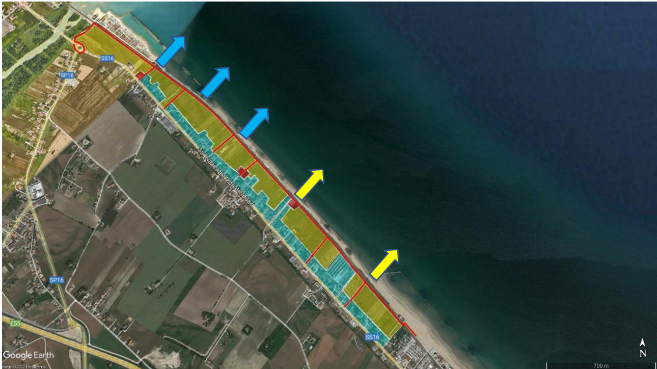
Figura 29 – Area di indagine (urbanizzata, in azzurro, agricola, in giallo), scarichi a mare esistenti (frecche azzurre) e in progetto (frecche gialle)
